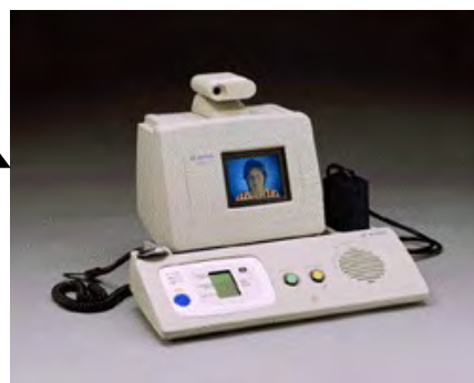
Pasient trykker grønn knapp for samtale og oransje knapp for hjerte og lungelyd
